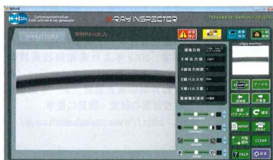
図9 電線検査ソフトによる表示画像
