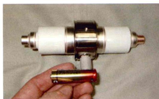
図2 針葉樹型カーボンナノ構造体冷陰極電子源を搭載した省電力X線管
