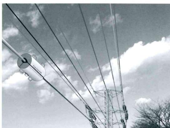
図6 自走式電線用X線検査装置
