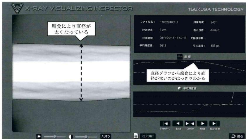
図1 腐食電線の撮像結果
