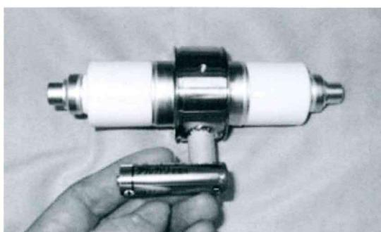
写真1 単3乾電池駆動小型X線装置用
