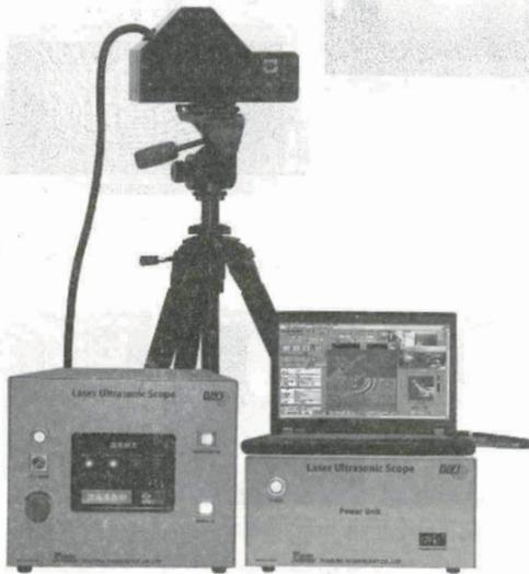
第10図 レーザ超音波可視化検査装置LUVI
