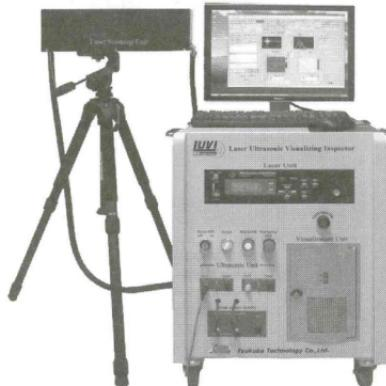
第1図 レーザ超音波可視化検査装置
