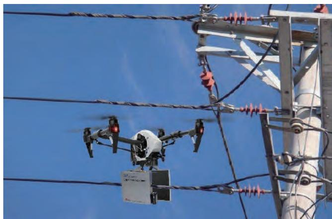
ドローンと組み合わせて、遠隔制御撮影を実現し、リアルタイムで検査結果を確認できる
